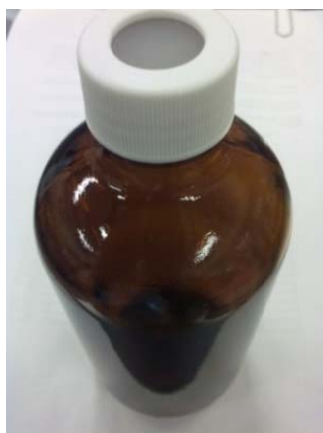
Figura 5.3. (a) Botella de reacción de 250 ml con septo y (b) Prueba montada de potencial bioquímico de metano
