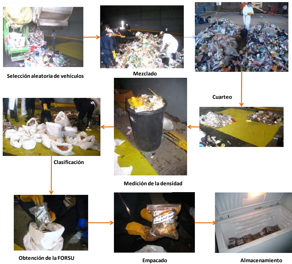
Figura 6.2. Esquemático de la toma de muestra de la FORSU en las estaciones de transferencia hasta su almacenamiento.
