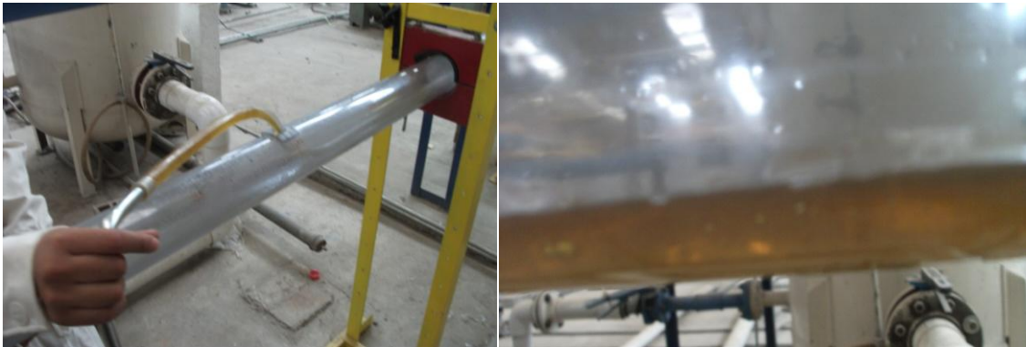
Fig. 3.13 Inyección del fluido no Newtoniano en la tubería.
