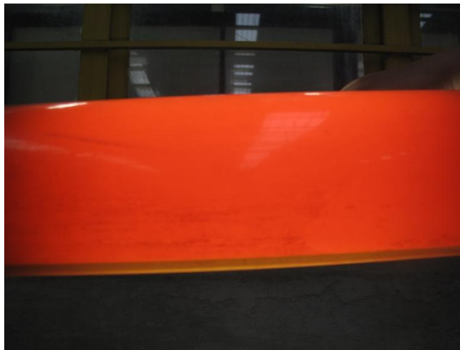
Fig.4 3 Colgamiento del fluido no newtoniano para la velocidad de 0.423 [m/s].
