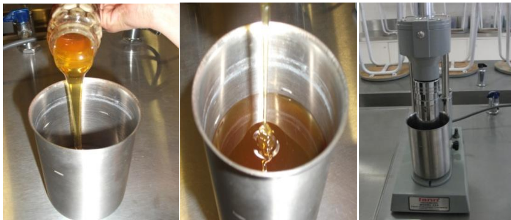
Fig. 3.6 Procedimiento de medición del esfuerzo de corte.
