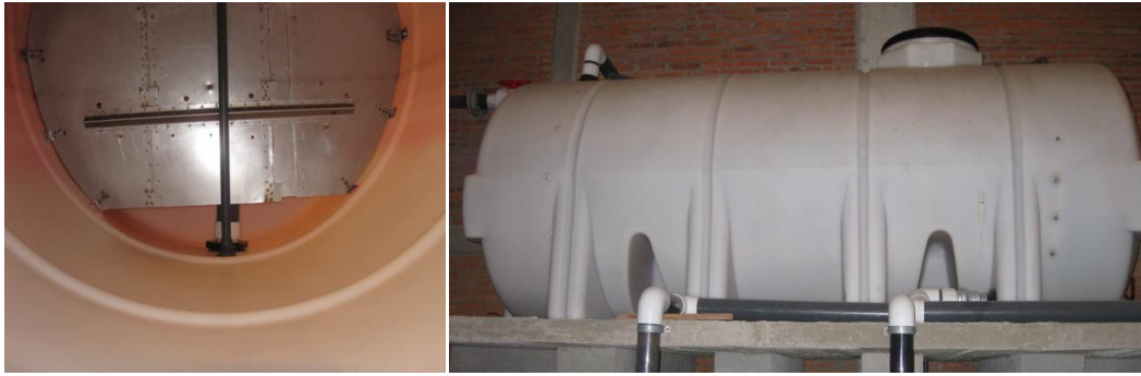
Fig. 2.7 Separador trifásico y mampara de choque.
