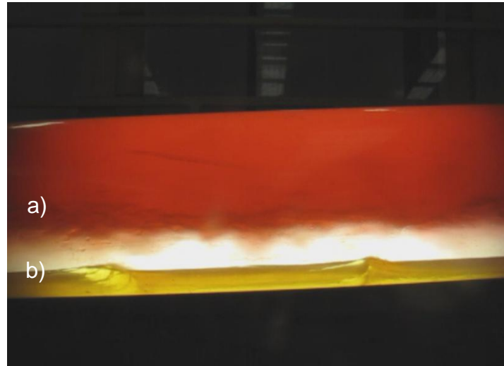
Fig.4.6 a) Flujo estratificado con mezclado en la interfaz. b) Flujo estratificado con lecho móvil (generación de dunas de FNN)
