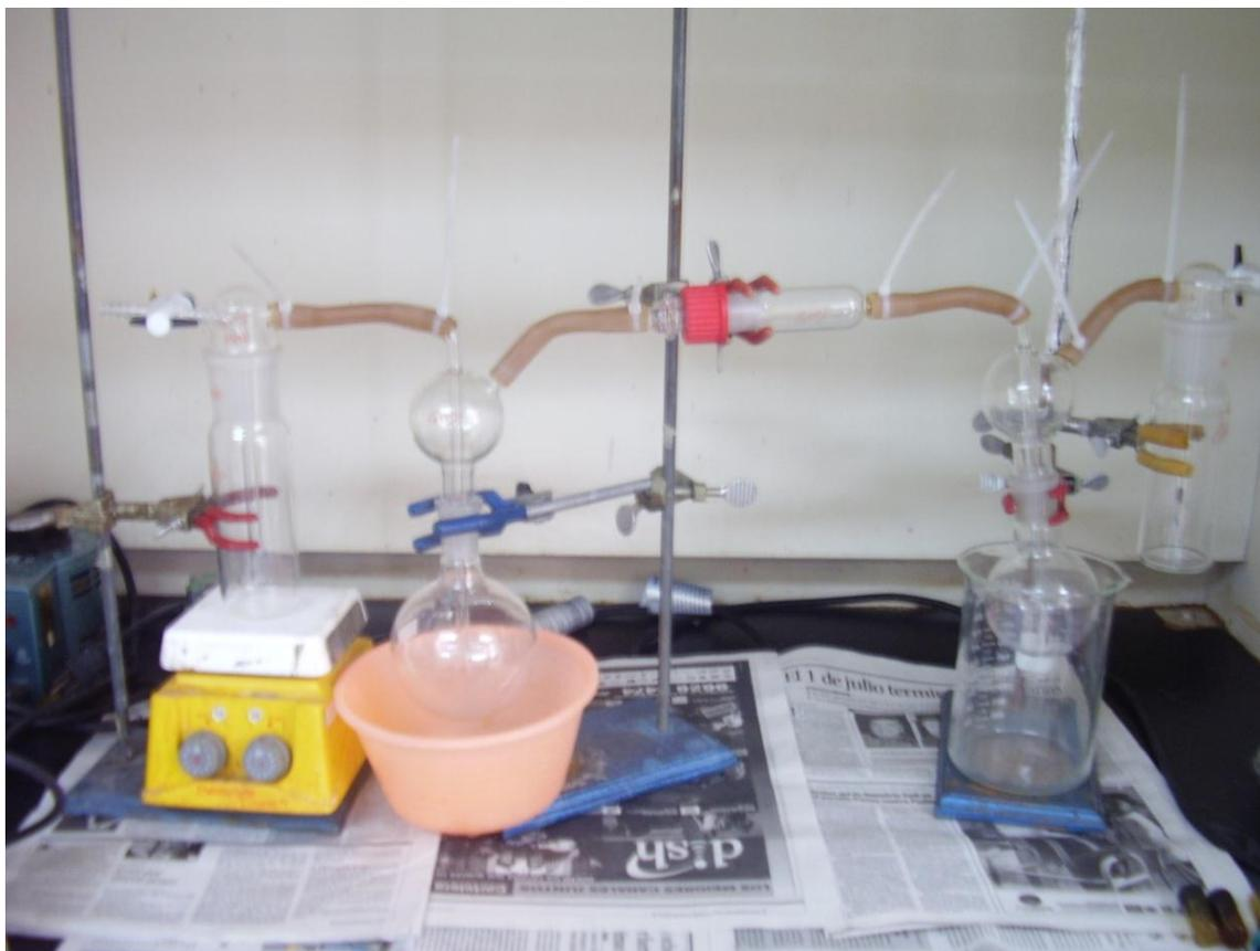
**Figura 4.2.** Sistema para la producción de dióxido de cloro en el laboratorio
