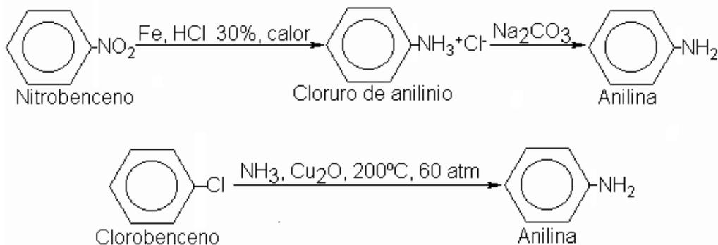
**Figura 2.6.** Reacciones de síntesis de anilina más usadas a nivel industrial (Suatoni, Snyder et al., 1961)
