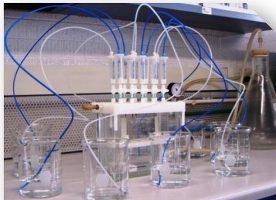
**Figura 4.8. Sistema de extracción en fase sólida (SPE).**
