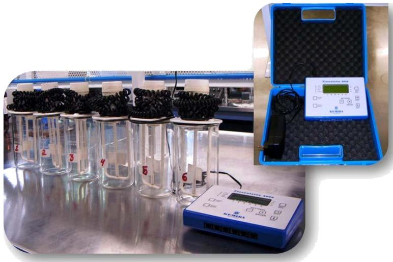
Figura 4.11. Equipo de prueba de jarras *Kemira Flocculator 2000*.
