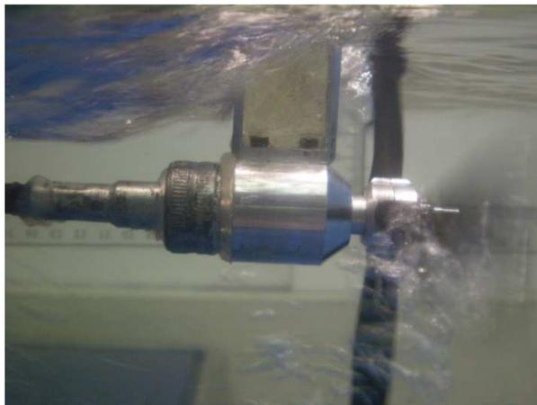
Fotografía 5-3. Aire atravesando el rotor de la THC.
