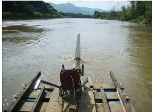
Fotografía 2-2. Rotor parcialmente fuera del agua. Hidrored (2003).
