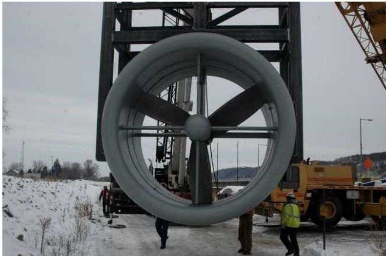
Fotografía 2-3. Turbina hidrocinética comercial, potencia 35 KW, río Mississippi, E.U.A.
