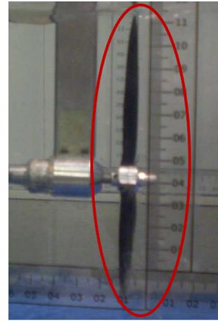
Fotografía 4-1. Sistema de propulsión de la THC.
