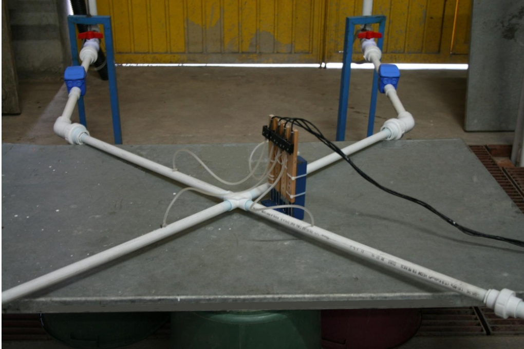
Fotografía 5. Detalle de los sensores de presión.
