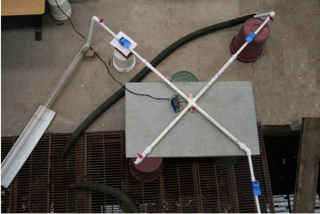
Fotografía 7. Cruce con alimentación individual (trifurcación).
