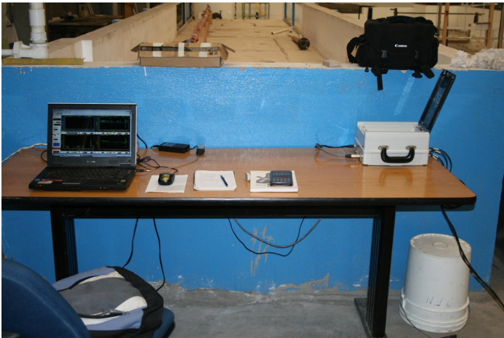
Fotografía 6. Sistema de almacenamiento de datos: consola de adquisición y software de lectura.
