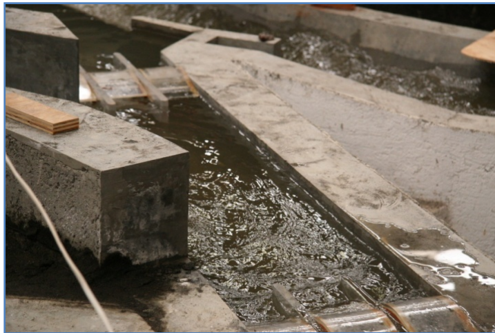
Fig. 5.2.3.3.1 TEC y TEO con descarga de diseño y compuertas abiertas
