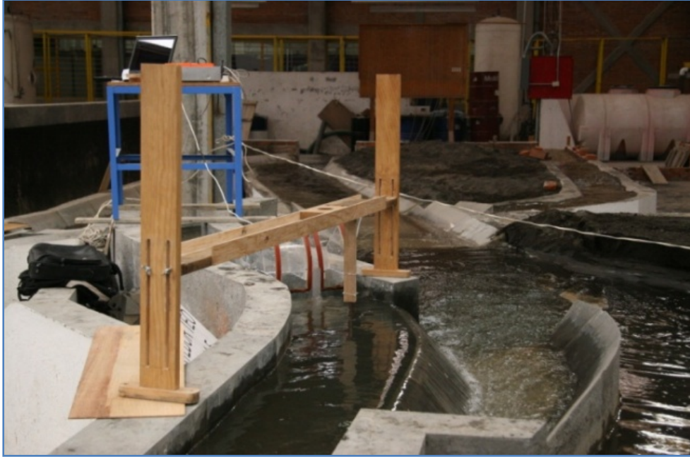
Fig. 5.2.3.1.2 El TEO con 170 m 3 /s, con compuertas totalmente abiertas. Medición del nivel en la sección 1
