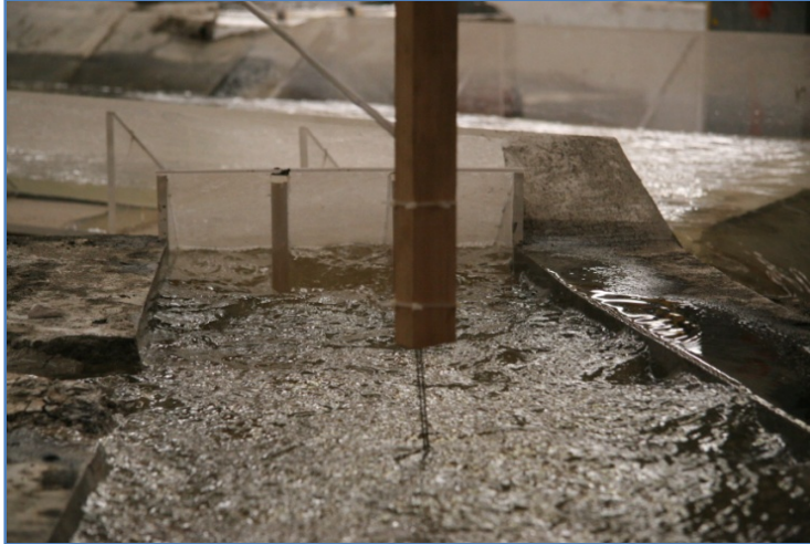
Fig. 5.2.3.3.2 Medición del tirante aguas abajo de la alcantarilla para el TEC y TEO con gasto de diseño y compuertas totalmente abiertas
