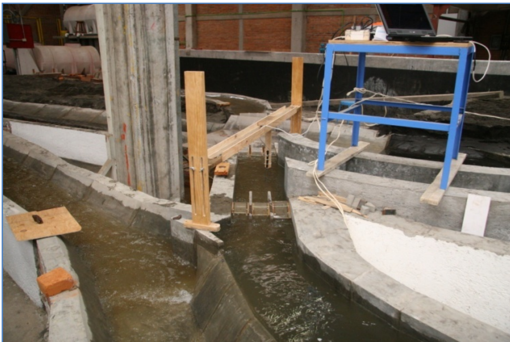
Fig. 5.2.3.2.1 Gasto de 150 m 3 /s por el TEC y compuertas totalmente abiertas
