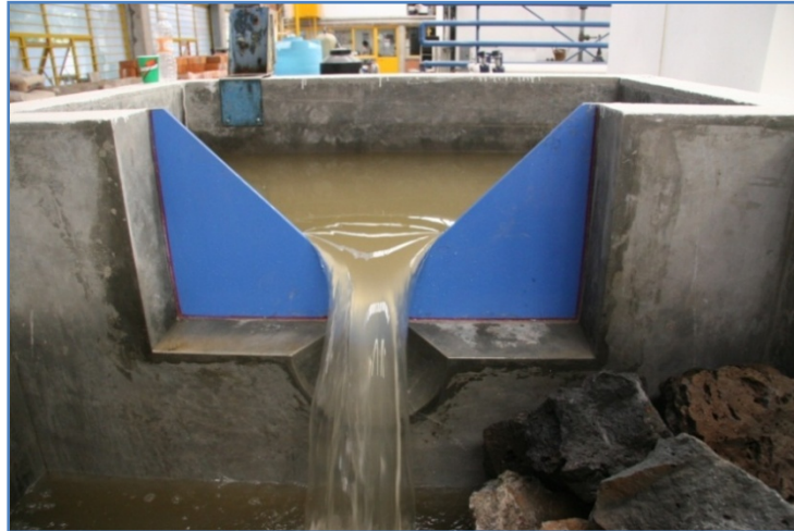
Fig. 3.4.1 Vertedor triangular para medir gastos en modelo
