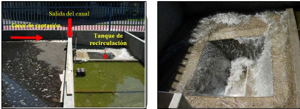
Fig. B.3.7 Obras de captación y recirculación del modelo
