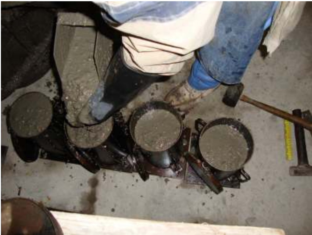
Se obtienen cilindros de concreto para ser ensayados.
