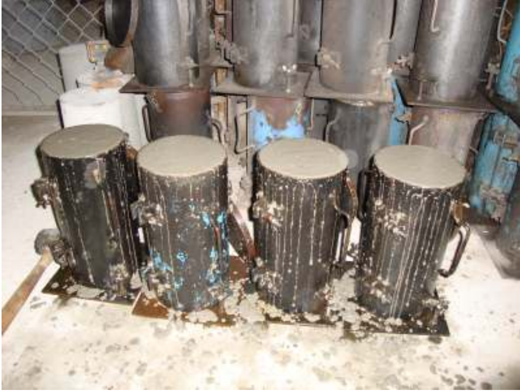
Muestra para ensayar y obtener resistencia del concreto.
