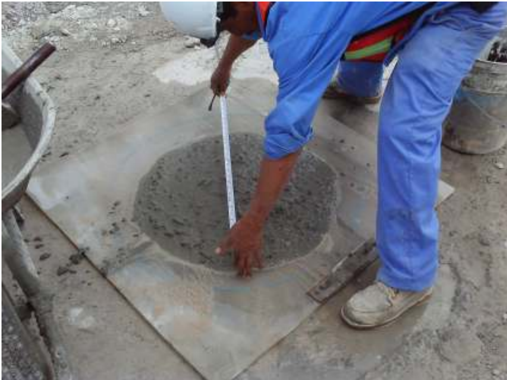
Se mide la extensibilidad de una muestra de concreto.
