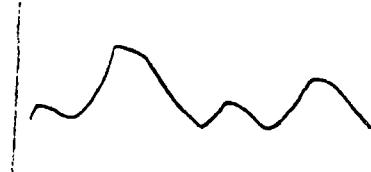
Salida de un microfono de cristal
