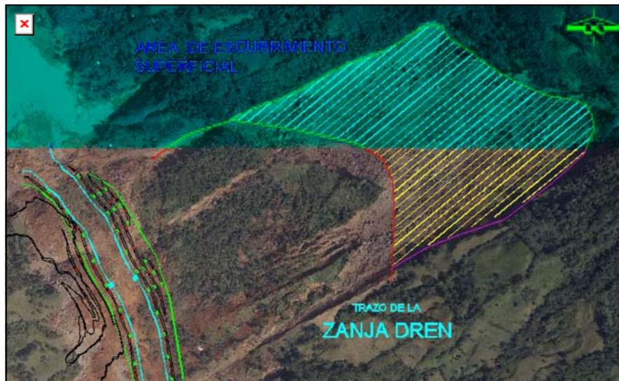
**Fig. 23. Esquema de la captación de escurrimientos de la zanja-dren.**
