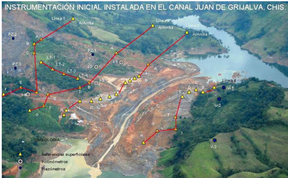
**Fig. 15. Instrumentación inicial instalada en el canal.**
