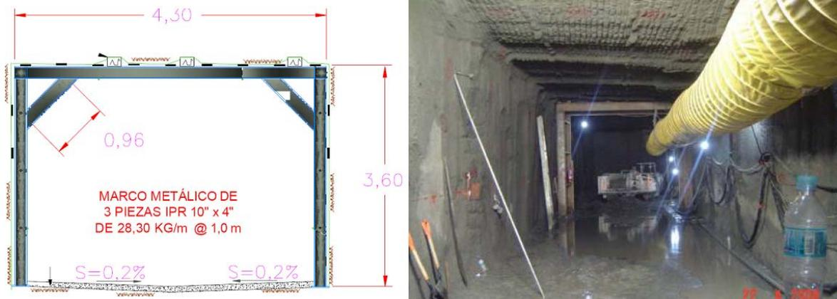
**Fig. 26. Esquema y vista de la galería de drenaje aguas abajo.**
