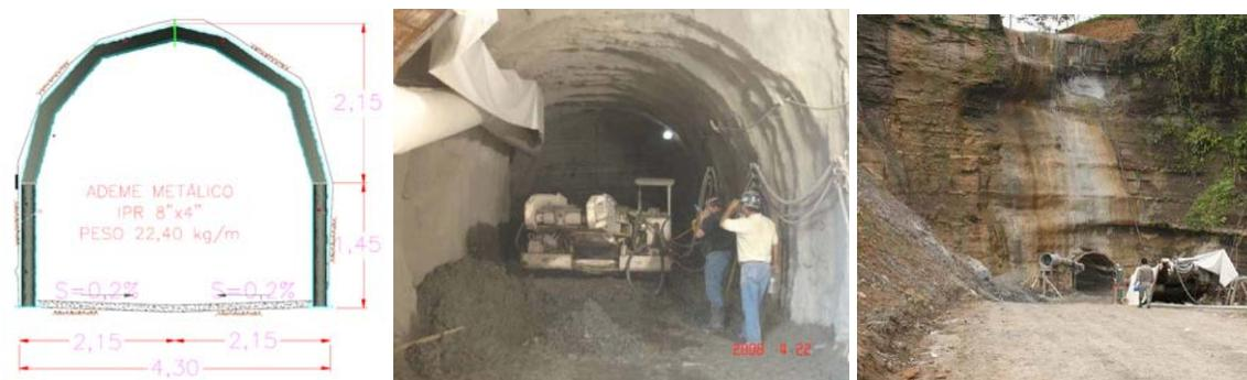
**Fig. 27. Esquema y vista de la galería de drenaje ubicada aguas arriba.**
