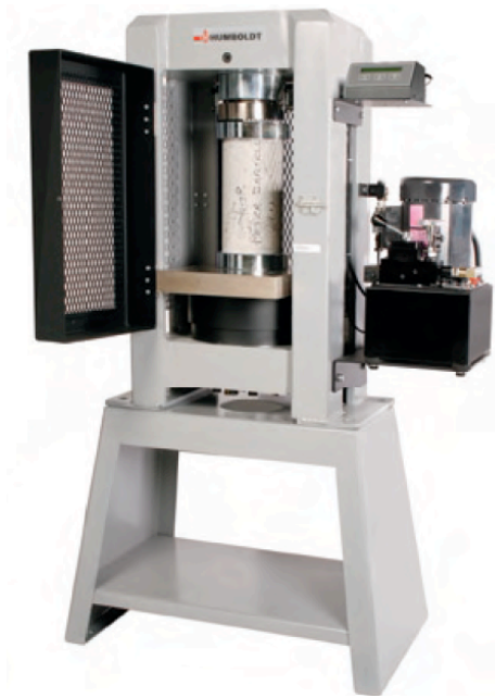
Fig. 78. Cilindro probado a compresión
