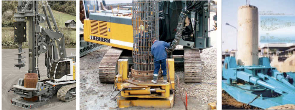
Fig. 32. Izq. y Medio: Osciladora LIEBHERR. Der.:Osciladora Casagrande
