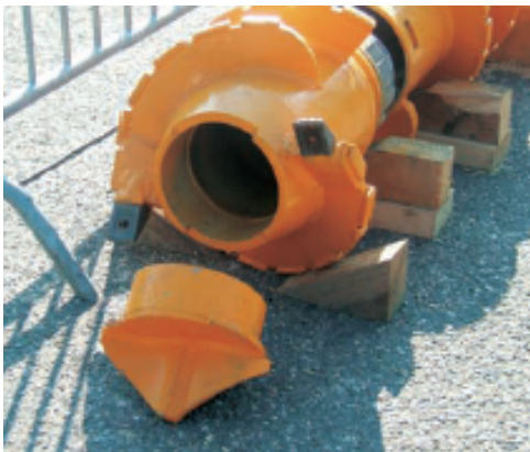
Fig. 57. Punta perdida para inyección de concreto o mortero (BAUER)
