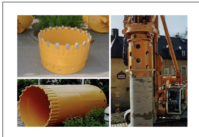
Fig. 26. Primera sección de ademe metálico con zapata de corte (BAUER)
