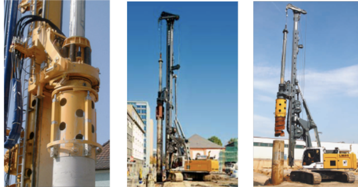
Fig. 25. Izq.: Adaptador de ademes BAUER. Medio y Der.: Perforadora rotatoria con adaptador de ademes LIEBHERR
