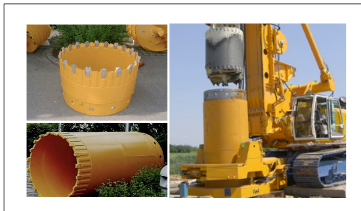
Fig. 33. Primer sección de ademe metálico con zapata de corte
