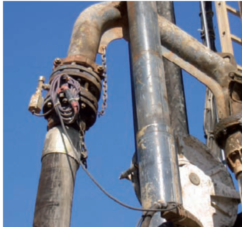
Fig. 76. Conexión de manguera con el alma de la hélice en el punto de alimentación de concreto o motero
