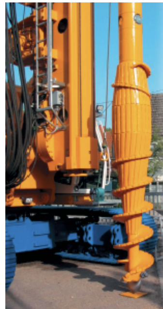
Fig. 58. Perforadora con hélice para desplazamiento total de suelo con hélice cónica (BAUER)
