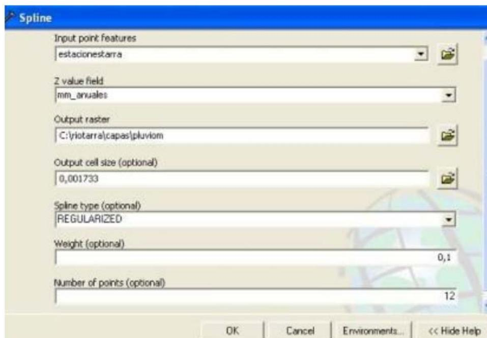
**Figura 17.** Pantalla con información para interpolación de datos de precipitación
