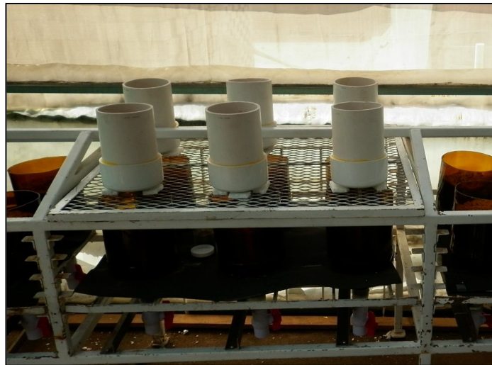
Figura 19. Columnas experimentales empacadas con el suelo contaminado con diesel
