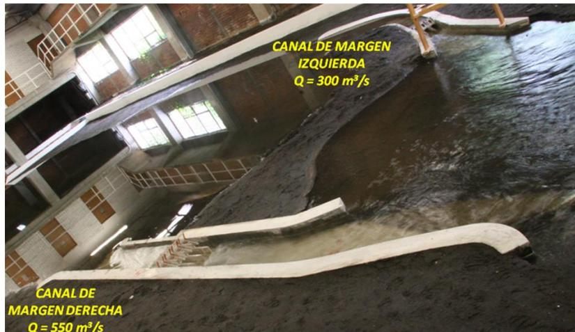
Figura 5.4 Fotografía del modelo del río Mezcalapa.
