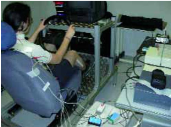
Figura 3.3.5.1 Configuración de la cabina [16]
