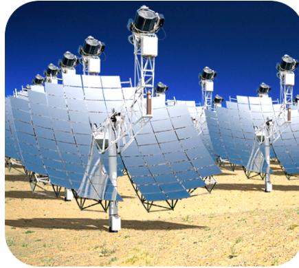
Fig. 6: Concentrador solar de plato parabólico [33]
