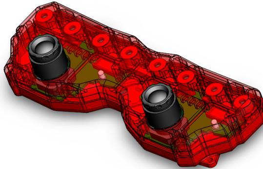
Fig. 1.7: Arreglo estereoscópico de cámaras
