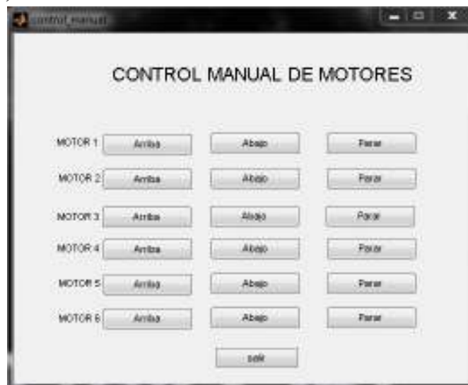
Figura 5.16 Subprograma control manual de motores.
