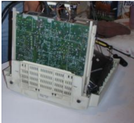
c) Placa de circuito impreso en el monitor
