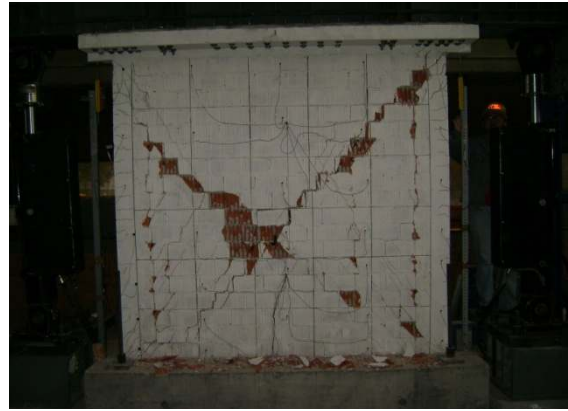
Fig. 4.17 Ensaye del muro ME4; a) Comienza a perder rigidez, se presentan las primeras grietas \gamma=0.0004 , b) \gamma=0.008 .
