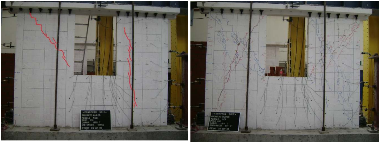
Fig. 4.7 Ensaye del muro ME8; a) Comienza a perder rigidez, se presentan las primeras grietas \gamma=0.0006 , b) Alcanza la resistencia máxima, \gamma=0.003 .
