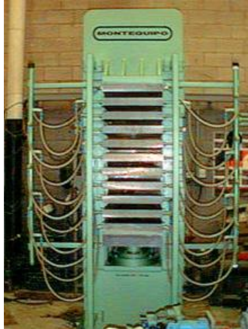
Figura 4.10 Prensa térmica para vulcanizado
