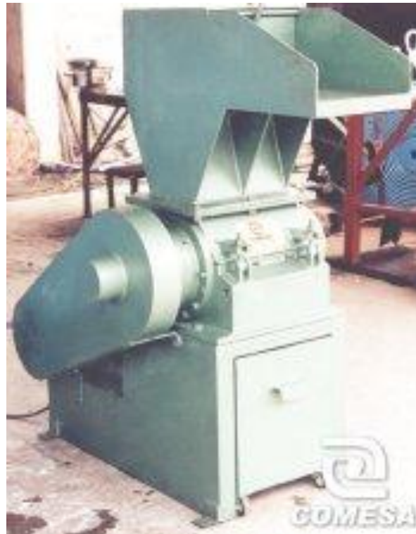
Figura 4.6 Trituradora de Cuchillas
