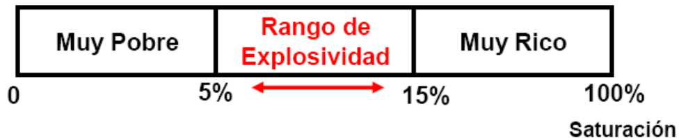
Figura II.11 Rango de explosividad del gas metano
