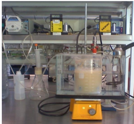
Figura 4. Reactor de producción de PHA
