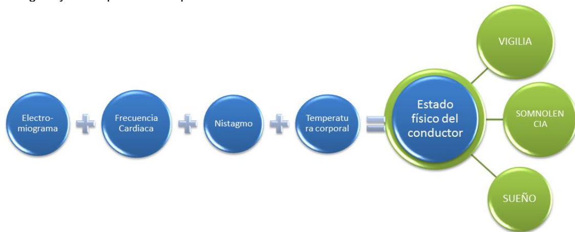
Figura 48 Propuesta del monitoreo de 4 bioseñales, para la identificación del estado de vigilia.
