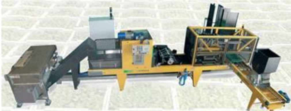
FIG 59 Línea automatizada de siembra, imag. int., 2010.
