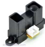
Figura 36. Sensor SHARP GP2Y0A02YK0F.
