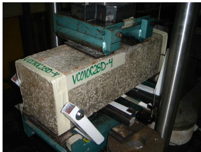
Figura 6.57. Textura en las vigas con mayor uniformidad
