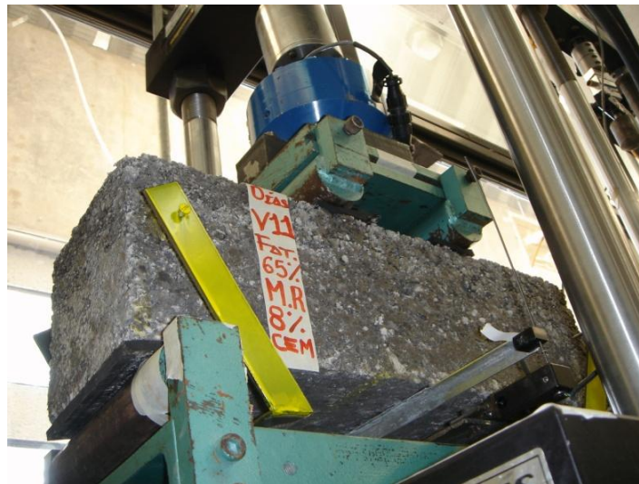
Figura 6.6. Viga ensayada a flexión para determinar módulo de ruptura y de elasticidad
