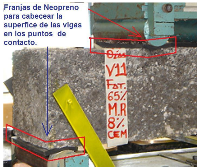
Figura 4.15. Colocación de franjas de neopreno en los puntos de contacto entre la viga y el equipo
