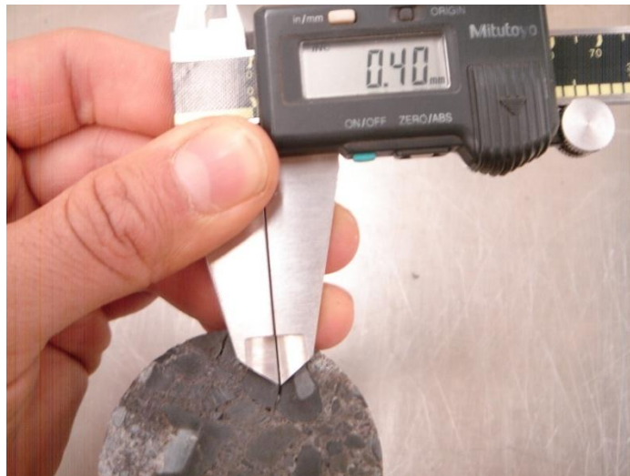
Figura 6.62. Rotura de agregado por efecto de la compactación del material
