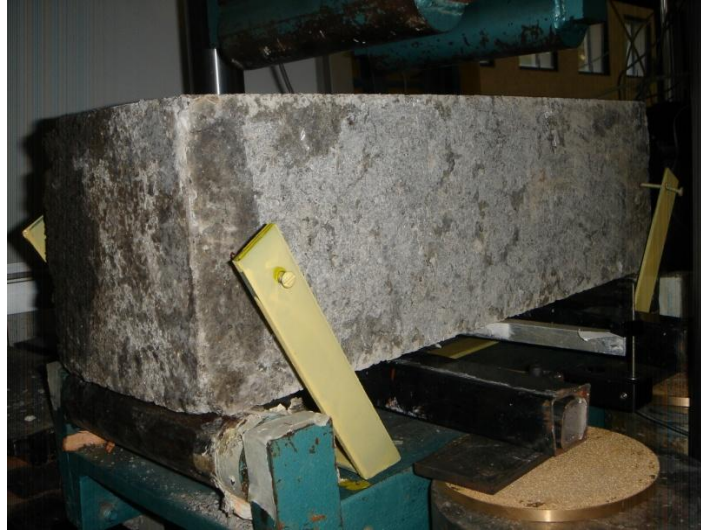
Figura 6.11. Viga colocada sobre base para prueba a flexión
