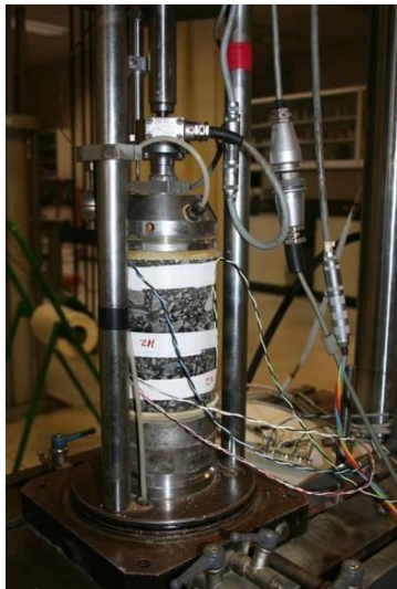
Figura 6.3. Instrumentación de probeta con strain gauges
