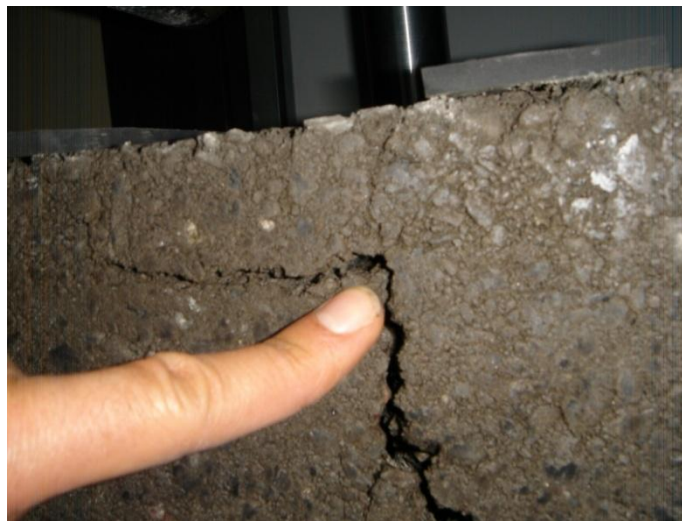
Figura 6.54. Falla de un espécimen a través de un plano de falla predefinido
