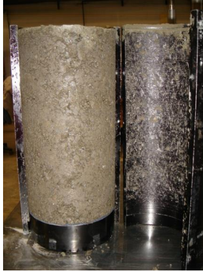
Figura 4.31. Extracción de la probeta cilíndrica del molde
