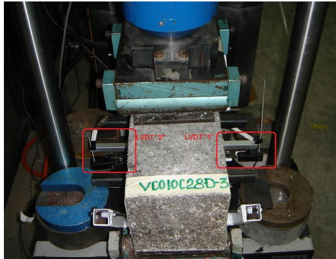
Figura 6.60. Doble medición de la deflexión en especímenes ensayados en marco de carga cíclica
