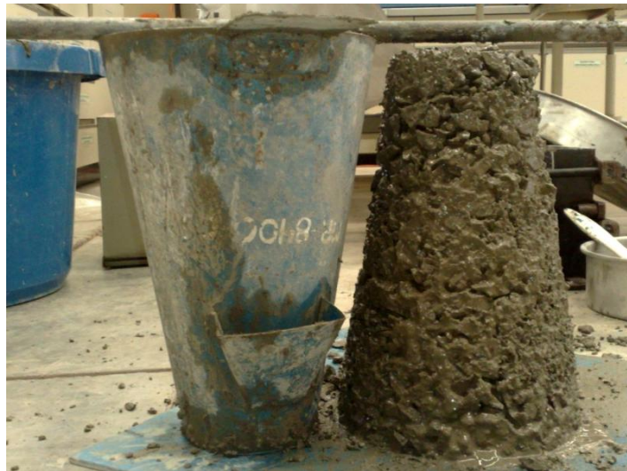
Figura 6.55. Cono de revenimiento en material de base
