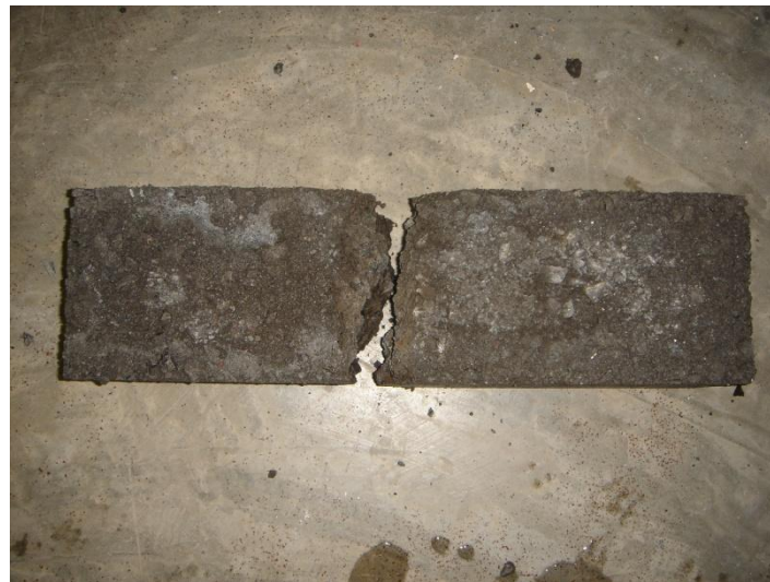
Figura 6.53 Ruptura típica de las vigas estabilizadas con cemento
