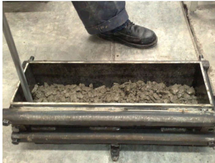
Figura 6.56. Varillado del material dentro de un molde rectangular
