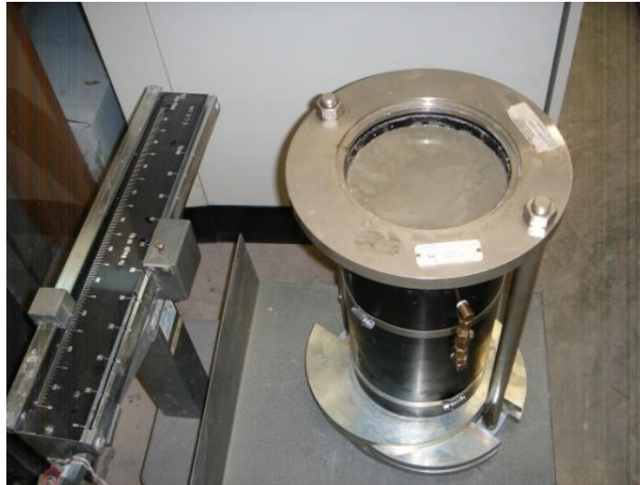
Figura 4.29. Molde empleado para la elaboración de probetas cilíndricas
