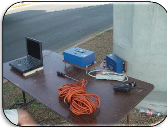
Figura 2.7 Sensores de medición de aceleraciones
