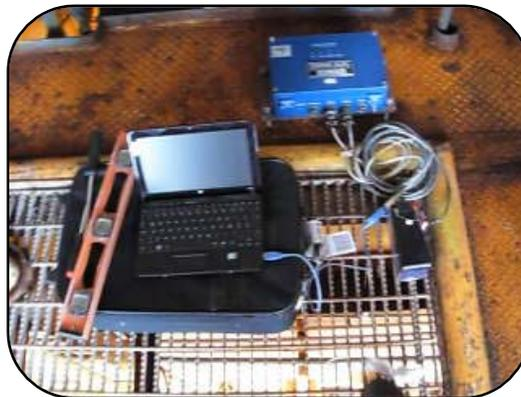
Fig. 4.1 Registrador digital GSR- 12 marca Terra- Technology
