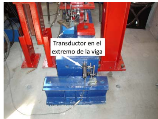
Figura 4.6 b.- Transductor para medir el desplazamiento horizontal de la viga.
