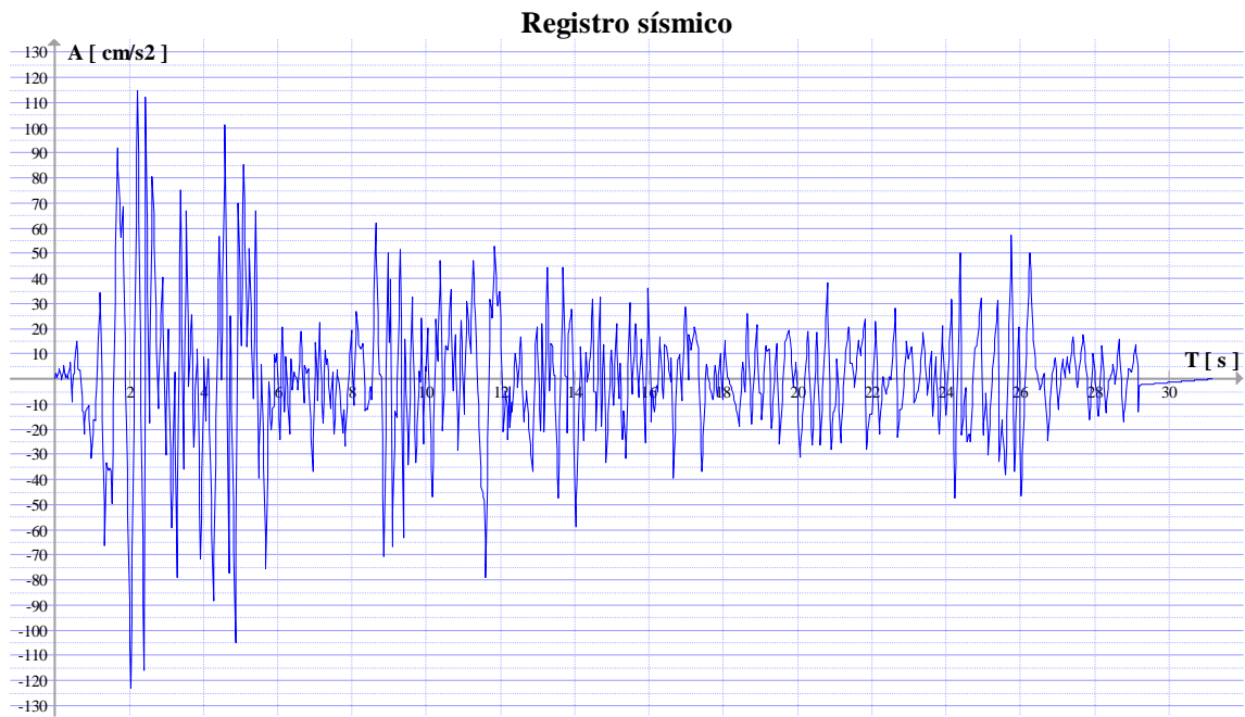
Figura 4.12.- Registro de aceleración utilizado en la prueba pseudodinámica en la que se empleó el marco.
