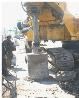
Fig. 3.3. Perforadora circular montada sobre orugas
