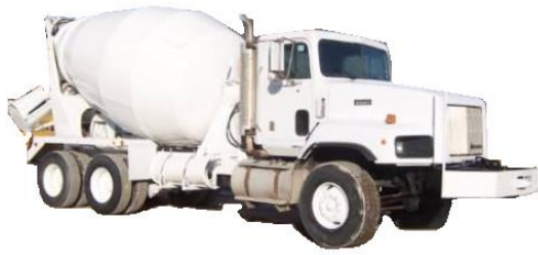
Revolvedora de concreto
