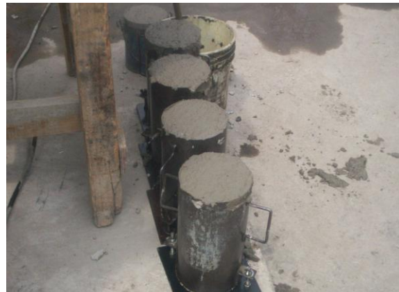
Fig. 2.11 Muestreo con cilindros para realizar la prueba de resistencia a la compresión
