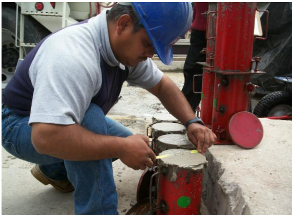
Fig. 2.11 Muestreo con cilindros para realizar la prueba de resistencia a la compresión
