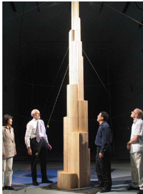
Figura 2.7 Prueba del modelo del Burj Dubai en el túnel de viento de RWDI
