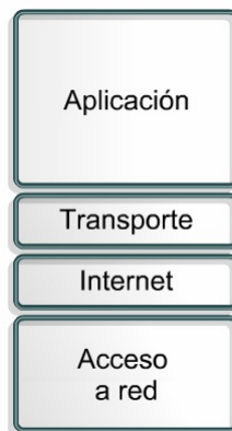
Figura 1.14: Capas del Modelo de Referencia TCP/IP
