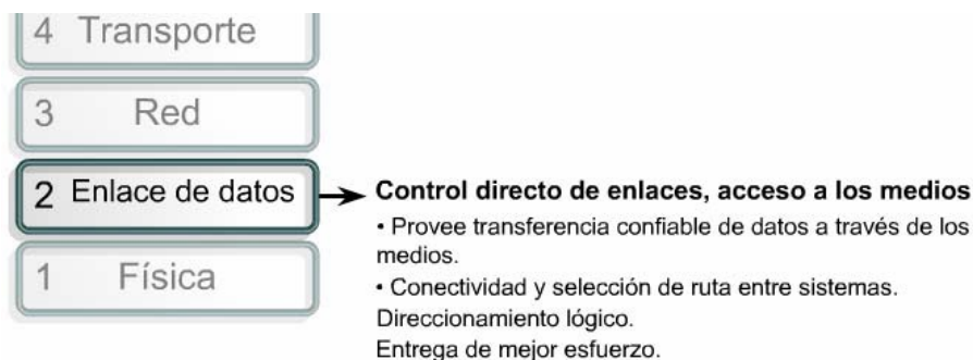
Figura 1.8: Características de la Capa de Enlace de Datos del Modelo OSI
