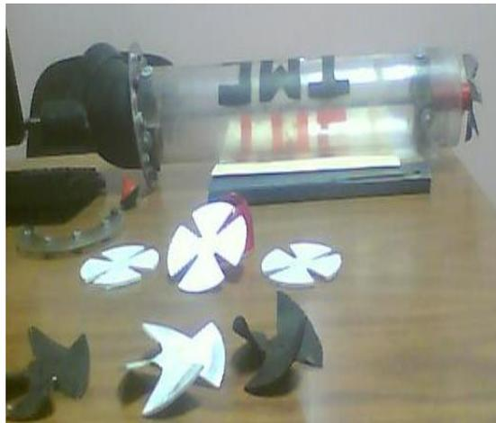
**Figura 33** Vistas del prototipo de la bomba.
