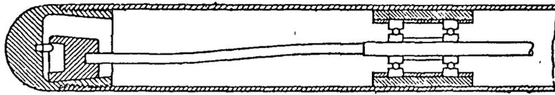
Fig. 3 Cabeza de un vibrador de inmersión
