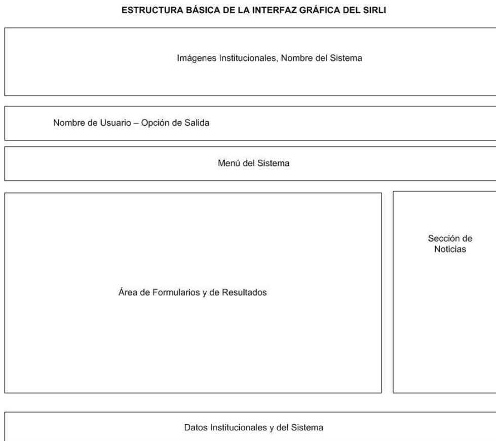
**Figura 3.3.** Modelado de la interfaz gráfica del SIRLI
