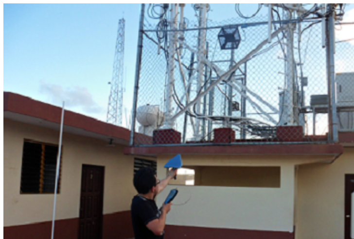
Figura 4.17. Medición de la potencia recibida de las señales inalámbricas.
