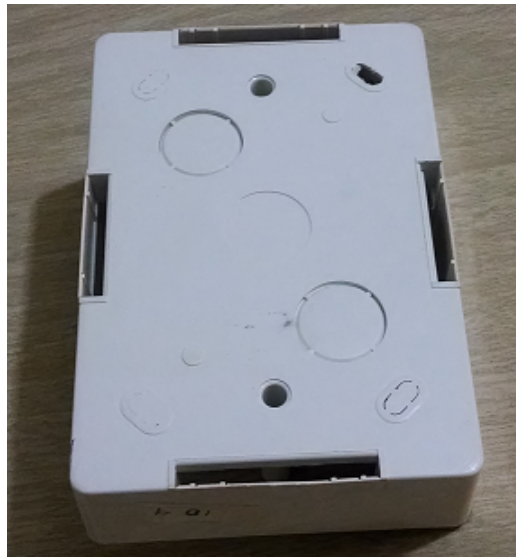
Figura 3.36. Perforaciones del gabinete del módulo controlador.
