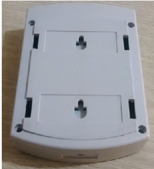
Figura 3.34. Inserciones plásticas para el módulo lector de tarjetas.
