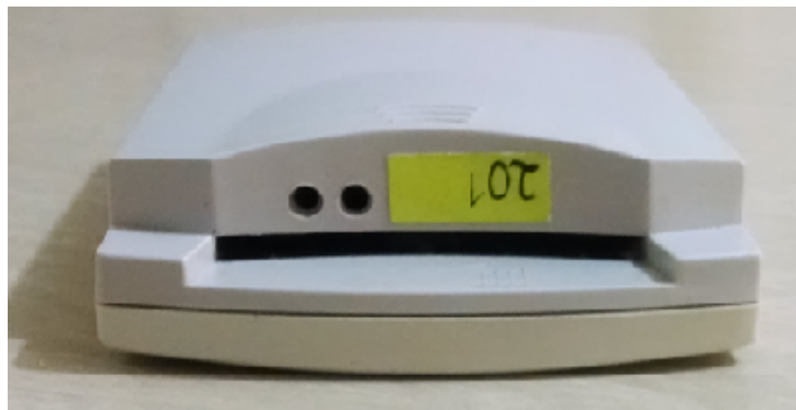
Figura 3.32. Ranura del gabinete del módulo lector de tarjetas.
