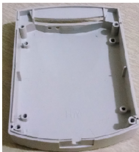
Figura 3.33. Sujeción para la tarjeta electrónica.
