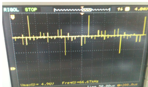
Figura 4.28. Voltaje de salida del regulador lineal.
