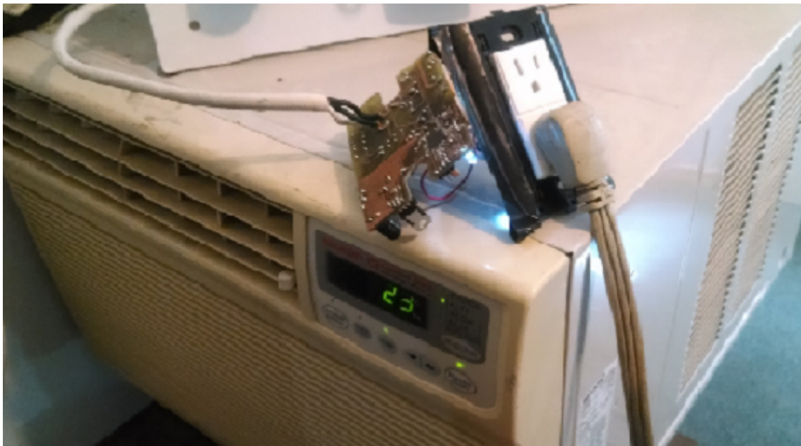
Figura 3.29. Acceso al suministro eléctrico desde la PC.
