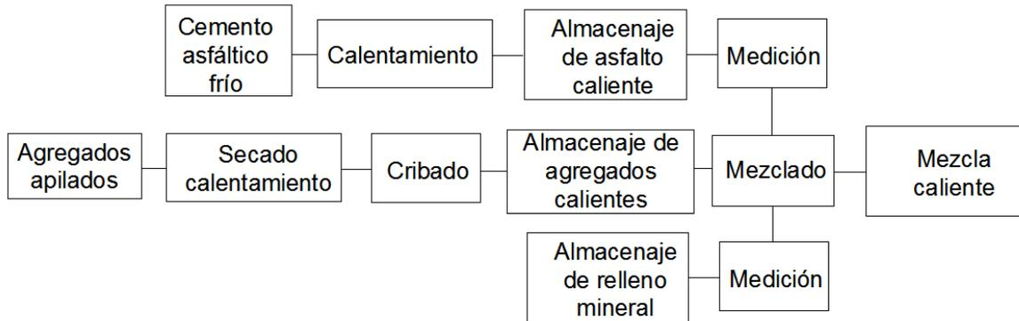
Figura B. Flujo de operación básica de una planta de dosificación.
