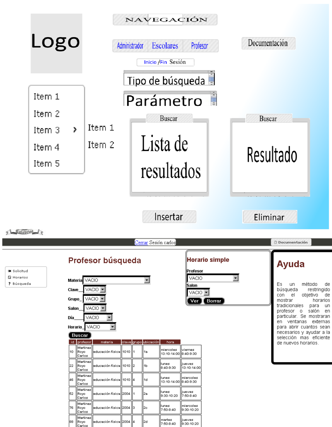
Imagen 4.30– Comparación, aunque la funcionalidad se respetó para todas las pantallas algunas tuvieron que ser modificadas por la gran cantidad de información que desplegaban.
