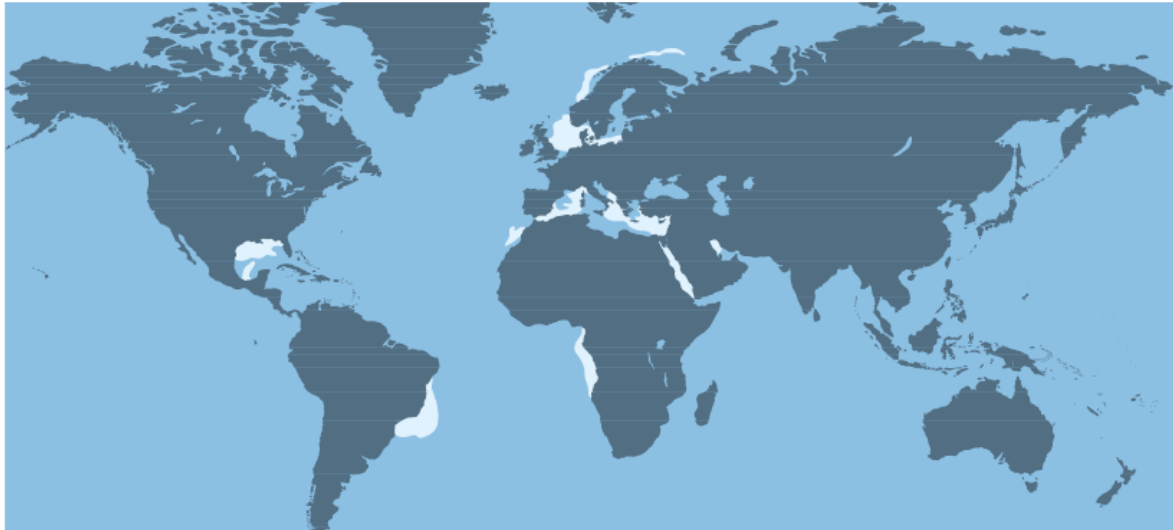
Figura A.12. Formaciones que contienen estructuras salinas en aguas profundas a nivel global. Las cuencas con mayor potencial se encuentran en el Golfo de México, Brasil, África Occidental y el Mar del Norte. (Aburto-Pérez et al., 2008)
