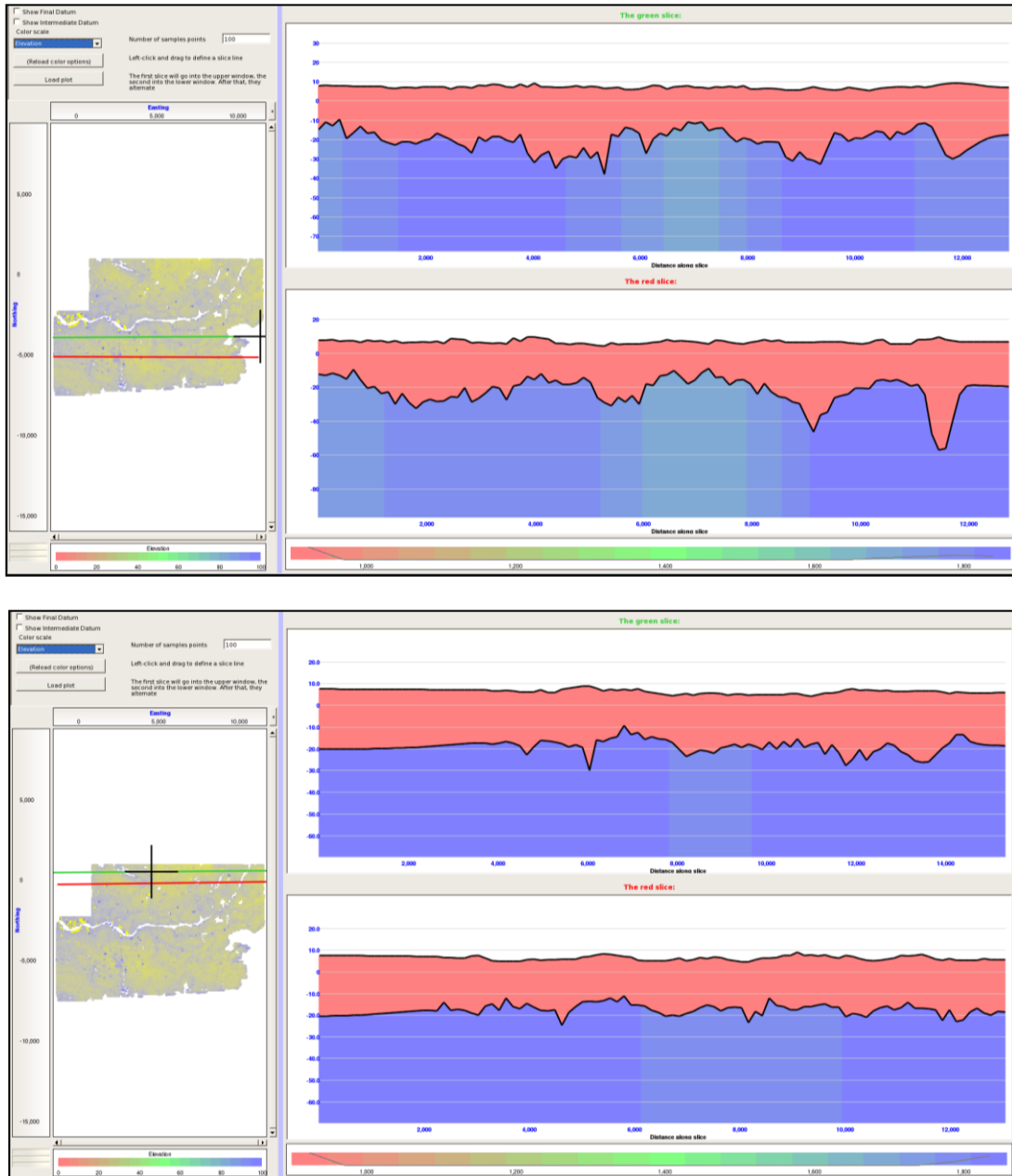
Figura 4.12 Modelo de refracción de la capa intemperizada del área de estudio.
