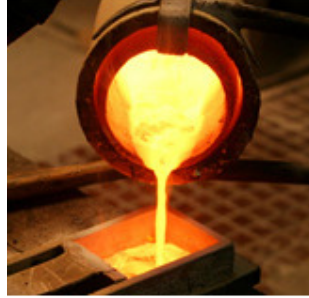
Figura 2.4 Fundición por inducción LUZARS Induction Heating® http://luzars.com/
