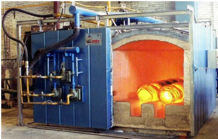
Figura 1.8 Horno industrial para tratamientos térmicos de LOBO HORNOS INDUSTRIALES ® http://www.lobohi.com/
