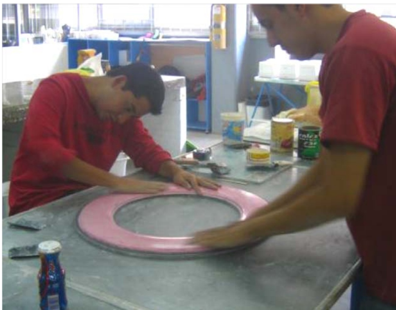
Figura 4-50: Lijado del molde positivo
