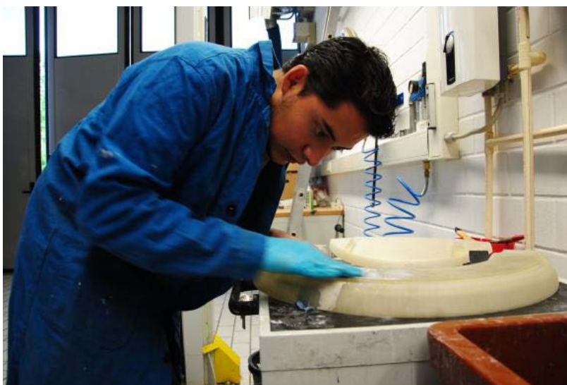
Figura 5-5: Lijado de las cubiertas
