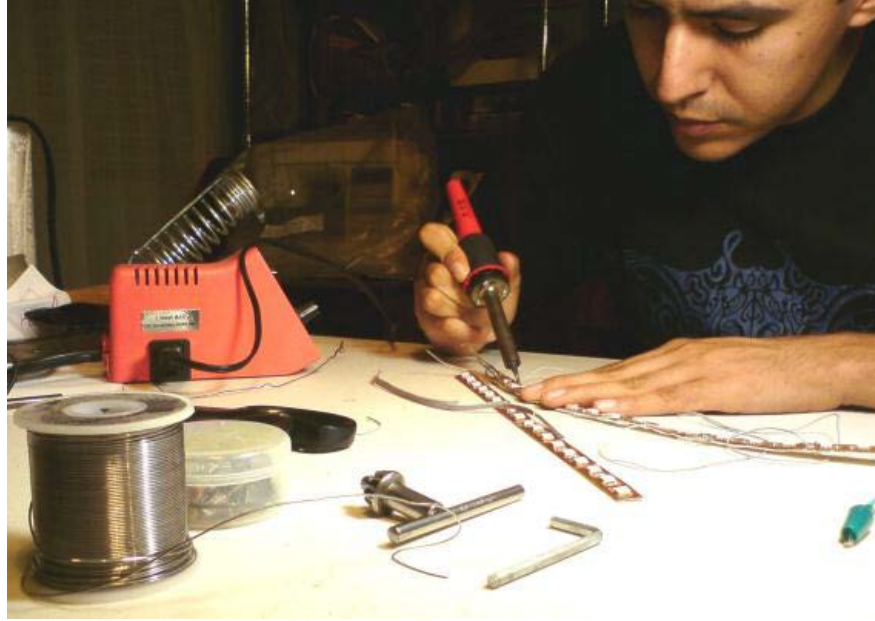
Figura 5-7 : Soldadura de las secciones de LED's.
