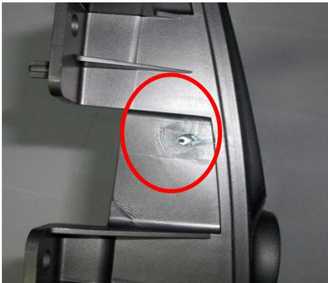
Figura 4.29.- Manchas mate en el punto de inyección
