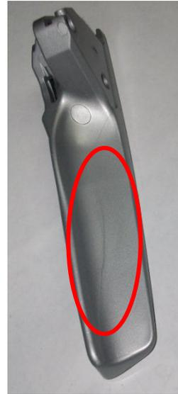
Figura.4.36.- Línea de unión o soldadura
