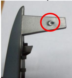
Figura.4.37.- Mancha mate en el punto de inyección
