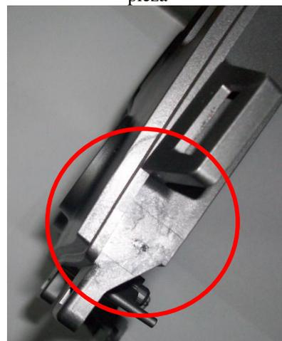
Figura.4.32.- Manchas mate en el punto de inyección
