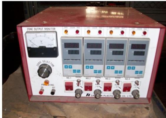
Figura 4.26.- Controlador de temperaturas marca SAN HSIN PLASTIC MOLD CO.
