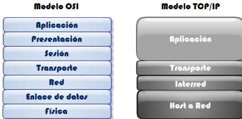
Figura 1. 6 Comparación entre el modelo TCP/IP y el modelo OSI.
