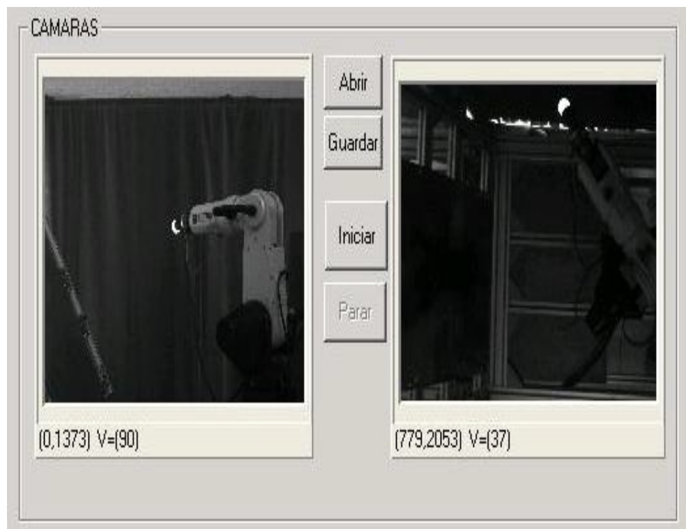
Figura 5.2: Visión de las cámaras al llevar el efector final hacia el fondo del área de visión de las mismas.
