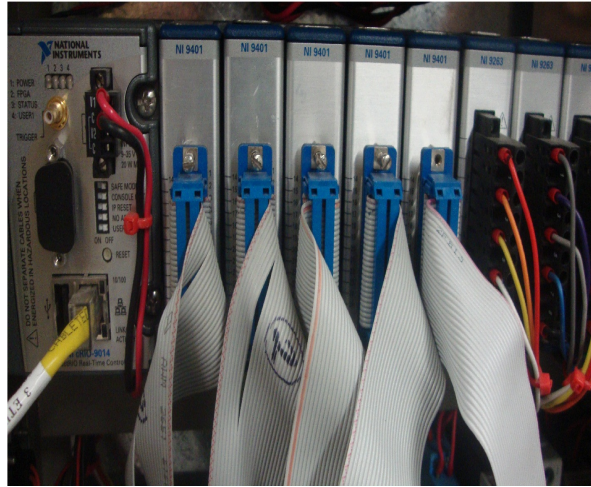
Figura 3.19: Módulo CompactRio NI 9401
