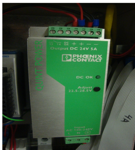
Figura 3.18: Fuente de Alimentación de las Tarjetas de Adquisición y Acondicionamiento
