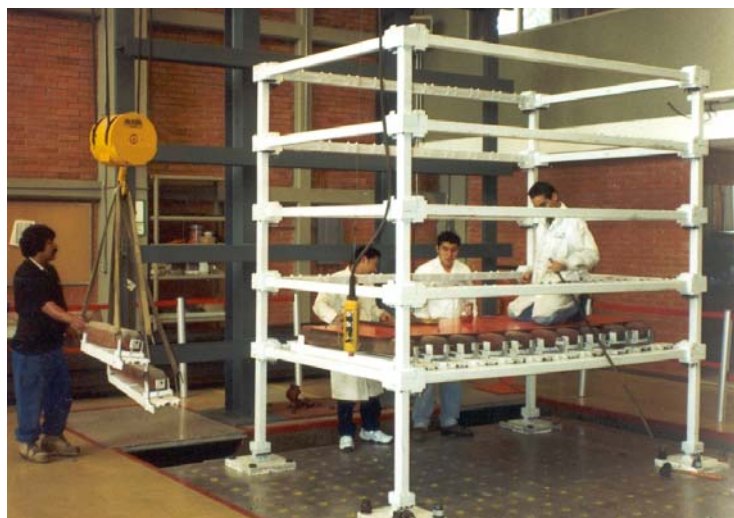
b) Montaje de sistema de piso
