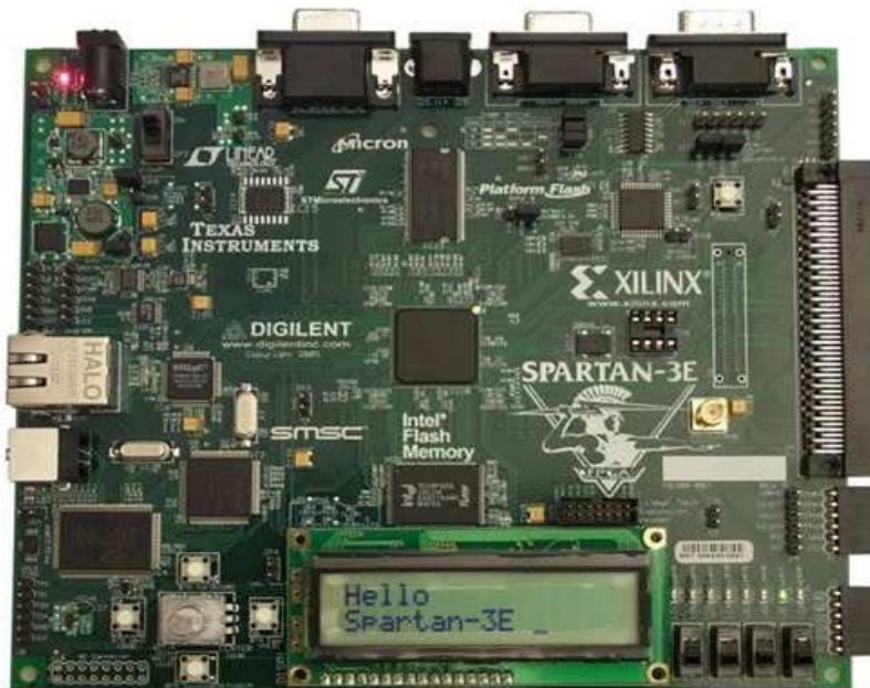
Figura 2.12 Vista superior de una tarjeta de desarrollo SPARTAN 3E de Xilinx.
