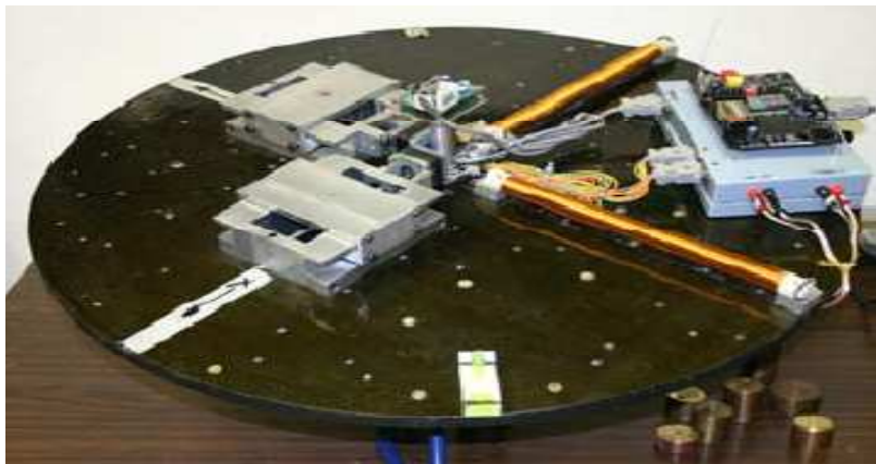
Figura 1.18 Bobinas magnéticas de una plataforma ADCS desarrolladas en el IG-UNAM.
