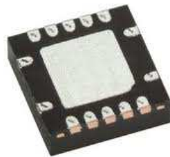
Figura 1.12 Magnetómetro analógico de dos ejes.
