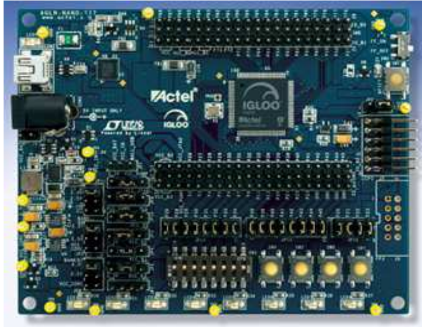
Figura 2.14 Vista general de la placa IGLOO de Microsemi
