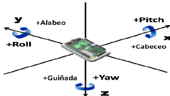
Figura 3.5 Representación gráfica de los ángulos de Euler.
