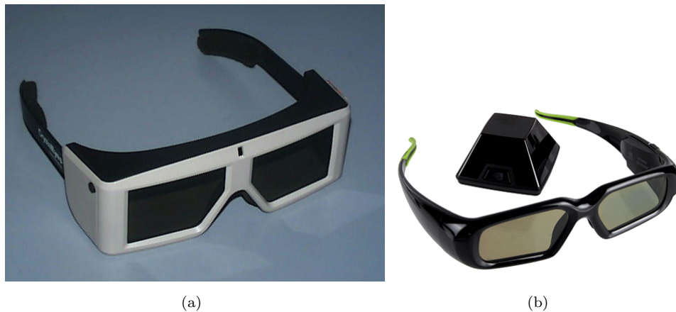
FIGURA 2.12: Ejemplo de dos sistemas de visión estereoscópica.(a)Crystal Eyes de la empresa Real3D[3].(b)Nvidia 3D Vision de Nvidia
