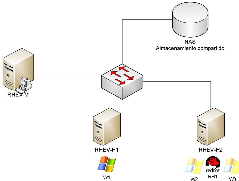
**Figura 3.4.** Esquema de virtualización RHEV con reparto de energía
