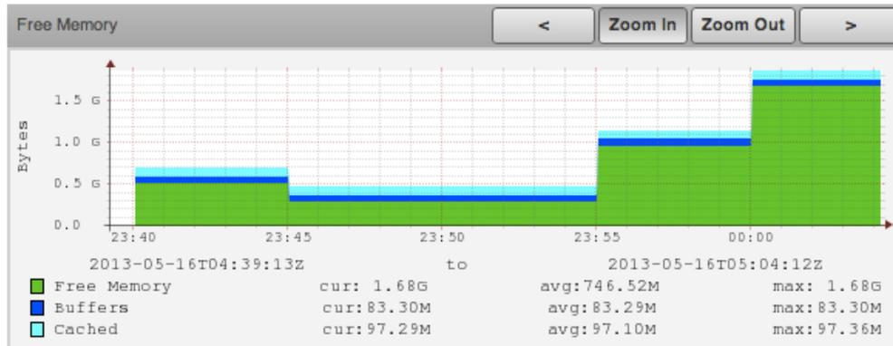
**Figura 7.14** Utilización de memoria RAM del servidor **lamp1.fi-a.unam.mx** con carga de trabajo.
