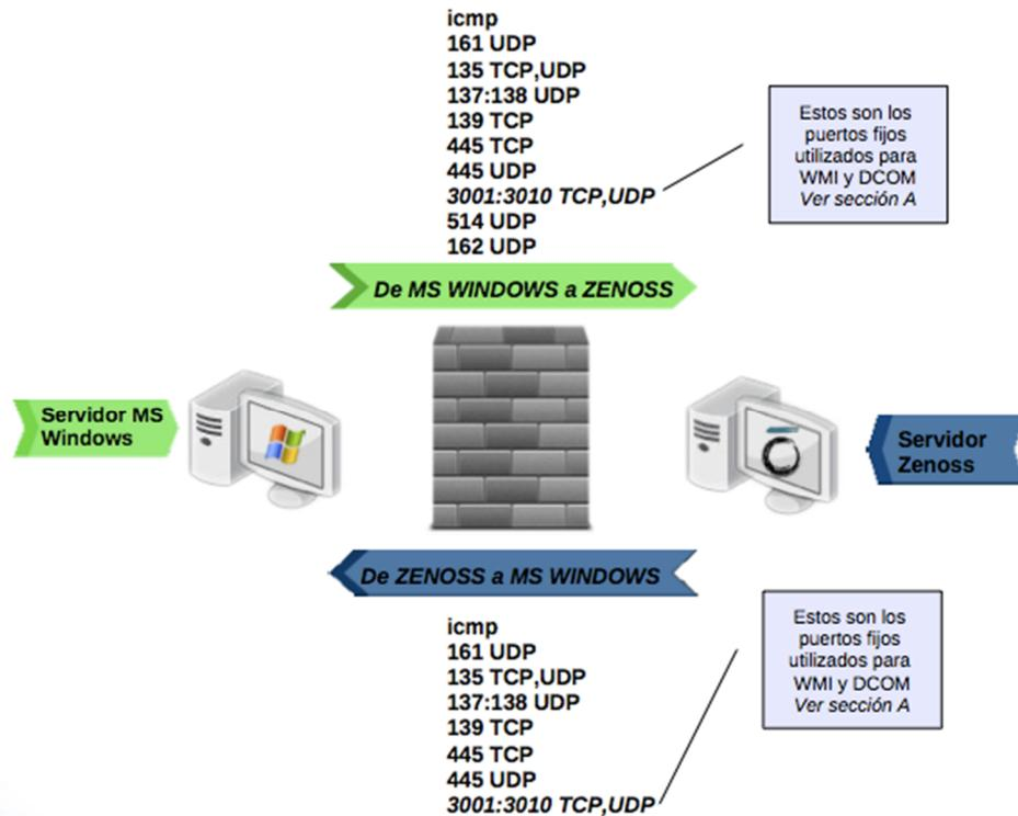
**Figura 6.4** Listado de puertos que deben considerarse en la reglas de filtro de un Firewall
