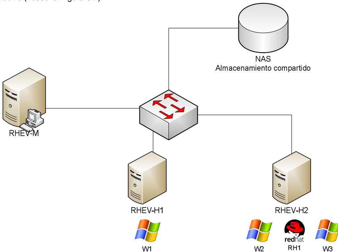
**Figura 3.2** Esquema de virtualización RHEV
