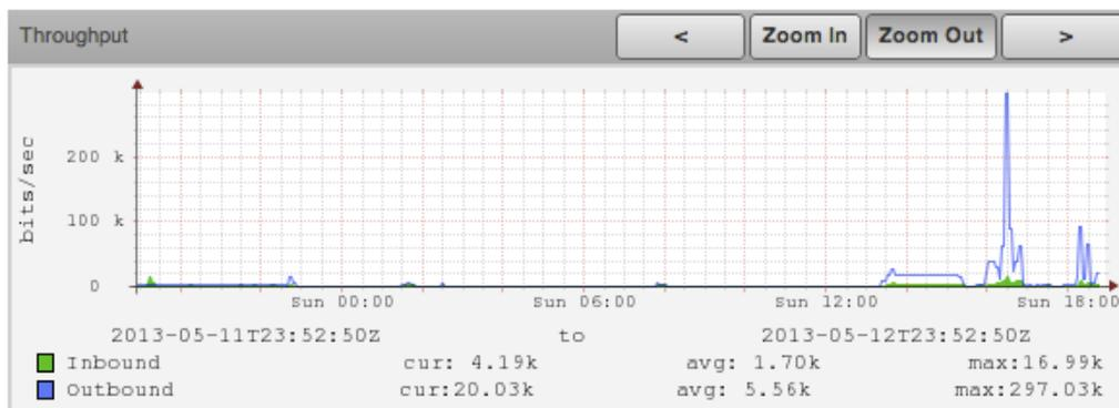
**Figura 7.9** Volumen de flujo de datos a través de la interfaz de red del servidor **hypervisor1.fi-a.unam.mx**
