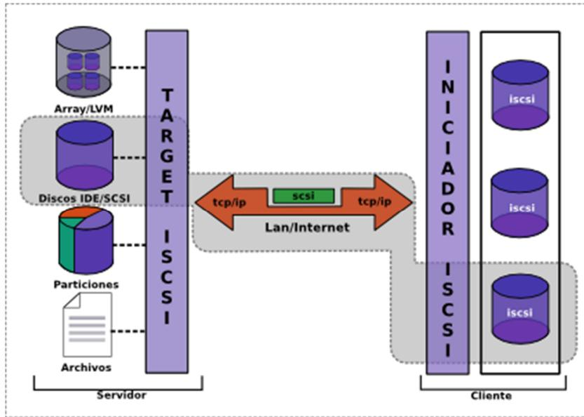
**Figura 2.6** Diseño de almacenamiento compartido por iSCSI
