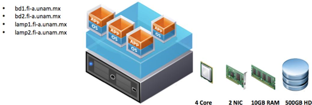
**Figura 7.6** Hypervisor1 compartiendo recursos de hardware con las máquinas virtuales
