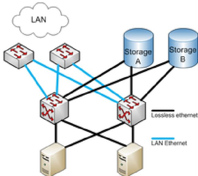
Figura 2.10 Diagrama de almacenamiento compartido por FCoE
