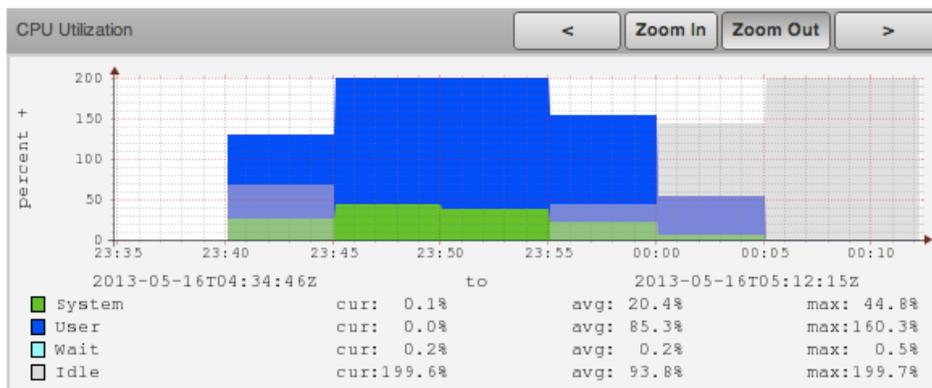
**Figura 7.13** Utilización en porcentaje de CPU del servidor **lamp1.fi-a.unam.mx** con carga de trabajo.
