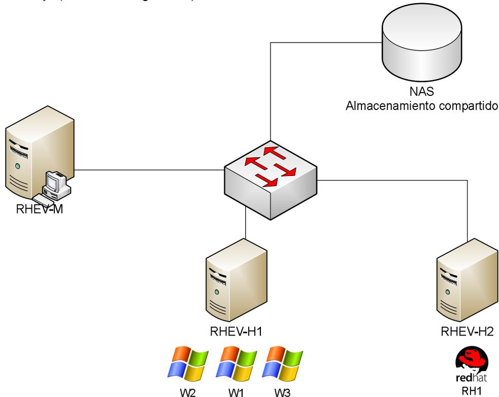
**Figura 3.3** Esquema de virtualización RHEV con ever Distribution
