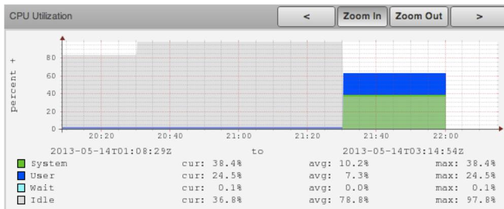
Figura 7.4 Utilización en porcentaje de CPU del servidor **lamp1-fisico.fi-a.unam.mx** con cargas de trabajo.
