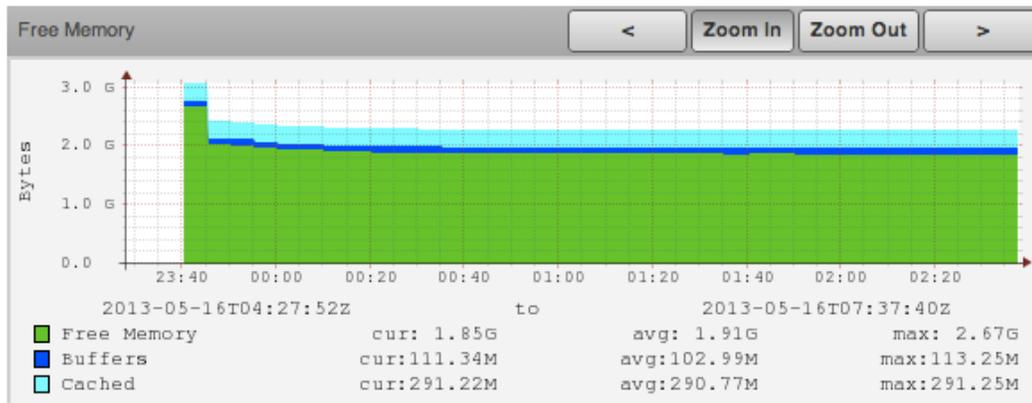
**Figura 7.16** Utilización de memoria RAM del servidor **hypervisor1.fi-a.unam.mx** con cargas de trabajo.
