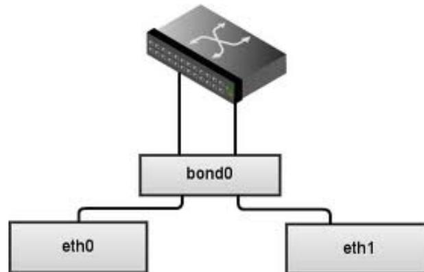
**Figura 4.18** Bonding de tarjetas
