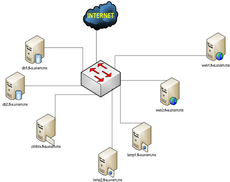
**Figura 1.1** Diagrama de red de USECAD
