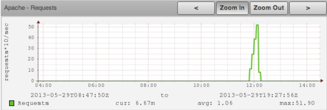
**Figura 7.18** La imagen muestra las peticiones por segundo al ejecutar `ab`, cada escalón en la gráfica es el fin e inicio de ejecución de cada comando.
